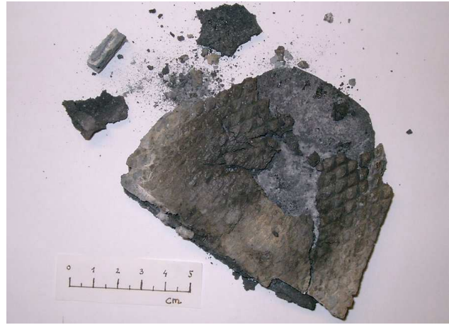
Abb. 59: Rohblei nach Einsatz als Anodenmaterial
