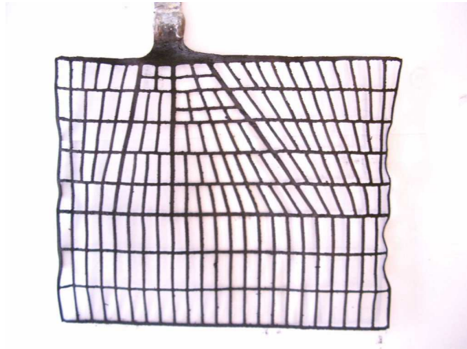
Abb. 17: Gitter nach dem Korrosionstest
