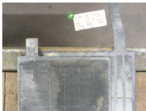
Abb. 43: Gussgitter im Vergleich zum DSL-Gitter
