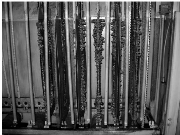
Abb. 9: Bleidioxid an nichtlöslichen Anoden nach der Blei-Kupfer-Abscheidung im Mäandermodul
