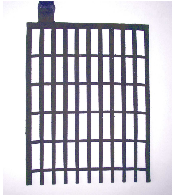
Abb. 40: oberes Teilgitter nach dem Korrosionstest
