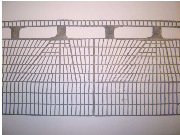
Abb. 15: Aus Fertigungsabfall hergestelltes Gitterband
