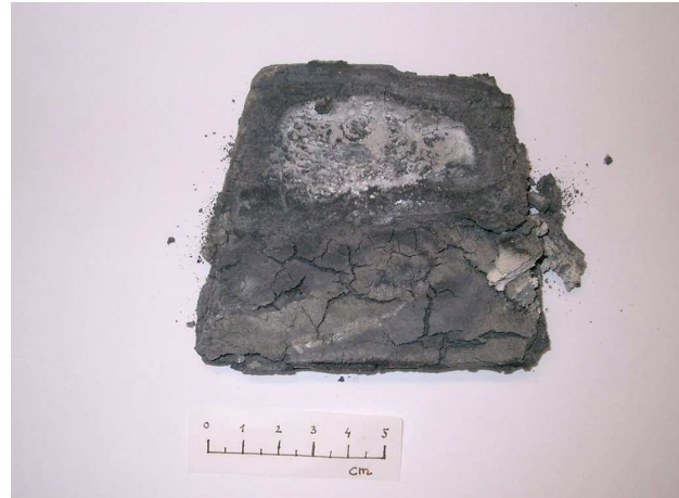
Abb. 61: Rohblei nach Einsatz als Anodenmaterial
