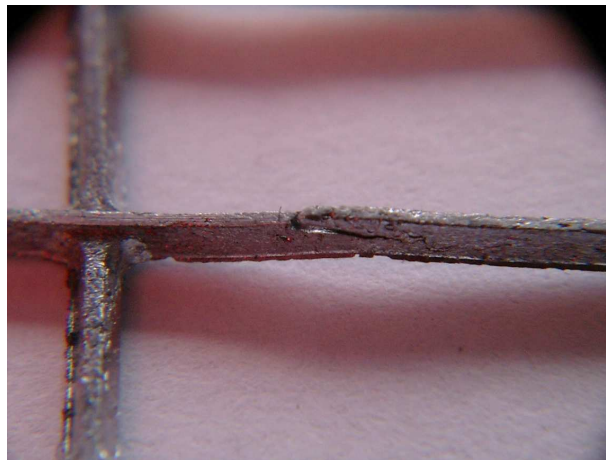
Abb. 50: Beispiel eines Stegbruchs im Concast-Ausgangsmaterial für die Nachbeschichtung
