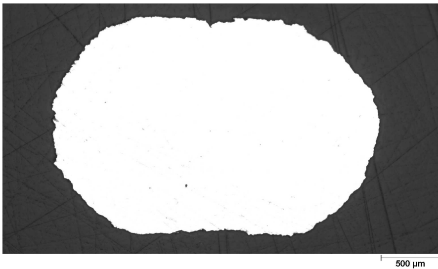
Abb. 38: polierter Querschliff eines Steges aus dem Gitter
